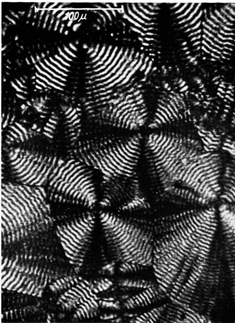
Abb. 1. Niederdruck-Polyäthylen (Marlex 50)-Sphärolithe mit Ringstruktur, aus der Schmelze kristallisiert (gekreuzte Nicols). Vergr. 300-fach.
